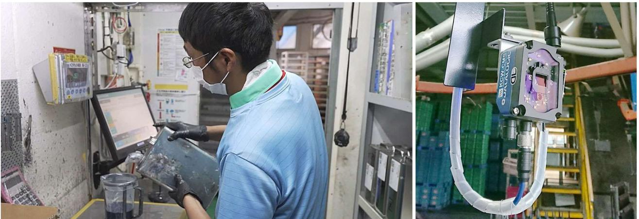
※工業塗装工場専用 IoT システム「KCW-CMS」を使った塗料調合。KCW-CMS はスプレー塗装や粉体塗装の他に電着塗装にも適用でき、ISO9001：2015 にも対応しています。
