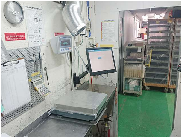
電子天秤(32kgまで)、 電子天秤用タッチパネル端末(PC)、 塗料缶用バーコードリーダー
