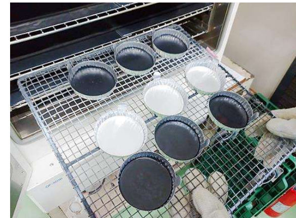
NV:アルミカップに使用塗料を入れ、乾燥前後の質量計測
