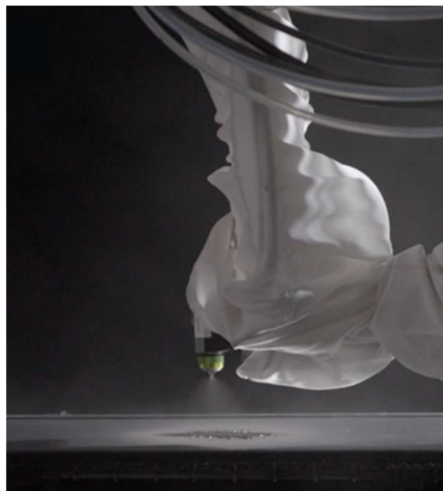
超高塗着塗装システム (塗料飛散：少)
